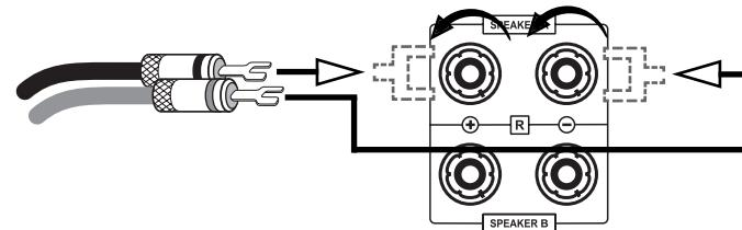
En l'absence de cosse, retirez l'isolant de chaque extrémité du câble sur une longueur d'un cm environ. Torsadez le câble dénudé, pour éviter les court-circuits, desserrez la molette de fixation en la tournant dans le sens antihoraire et insérez l'extrémité du câble dans le perçage dégagé du bornier. Serrez maintenant le câble en faisant tourner la molette de serrage dans le sens horaire. Contrôlez le serrage correct du câble.
