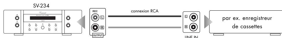
Reliez pour cela cette sortie de signal par une paire de câbles RCA, à l'entrée du signal (« LINE IN », « TAPE IN » ou « REC IN ») de l'appareil d'enregistrement.
