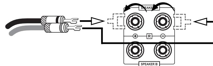
Andernfalls entfernen Sie ein ca. 1 cm langes Stück der Isolierung von jedem Endstück des Lautsprecherdrähtes. Verdrillen Sie die blanke Litze, um Kurzschlüsse zu vermeiden. Drehen Sie den Knopf der Lautsprecherklemme im Gegenuhrzeigersinn, um ihn zu lösen und führen Sie das blanke Drahtende in das nun freiliegende Klemmenloch ein. Drehen Sie den Knopf nun im Uhrzeigersinn, um den Draht in der Lautsprecherklemme festzuklemmen. Achten Sie darauf, dass die Verschraubung fest ist.
