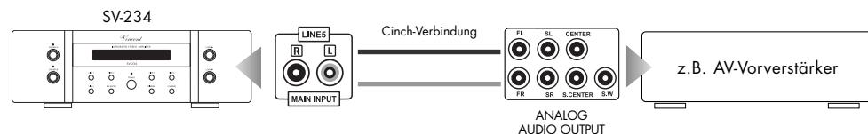
Ist der Eingang „LINE5“ gewählt, verhält sich der Verstärker SV-234 wie eine Stereo-Endstufe. Wenn sich der Verstärker SV-234 beim Betrieb als Endstufe automatisch mit dem Vorverstärker ausschalten soll, müssen die nachfolgend beschriebenen Kabelverbindungen für die Einschaltsteuerung richtig vorgenommen werden.
