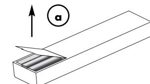
b) Entfernen Sie gegebenenfalls verbrauchte Batterien und legen Sie die neuwertigen Zellen, wie im Batteriefach schematisch dargestellt, richtig ein.
