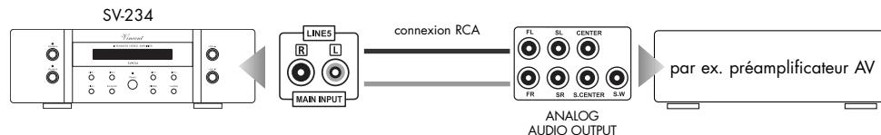
Si l'entrée "LINE 5" est sélectionnée, l'amplificateur SV-234 se comporte comme un étage de sortie stéréo. Si l'amplificateur SV-234 utilisé comme étage de sortie, doit être automatiquement mis à l'arrêt en même temps que le préamplificateur, les liaisons par câbles décrites ci-dessous doivent être effectuées correctement pour la commande de mise sous tension.
