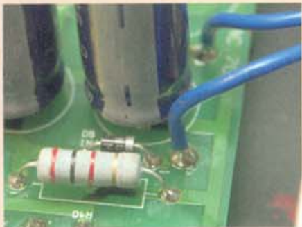
Das ist die Diode, die es hier zu entfernen gilt. Die beiden blauen Leitungen kommen von der 70-V-Hilfswicklung des Netztrafos – auch die müssen ab
