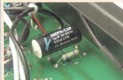
Das können wir besser und setzen an dieser Stelle auf klanglich anerkannt gute Zinnfolien-Typen. Die deutlich größere Bauform macht den Einbau nicht einfach, mit zusammengebogenen Anschlussdrähten geht's aber
