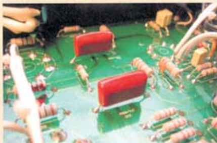
Wir können nicht garantieren, dass es in Ihrem Dynavox genau so aussieht, bei uns jedenfalls sahen die ursprünglichen Koppelkondensatoren so aus
