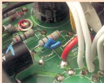
47 PicoFarad hatten wir gerade nicht zur Hand, also haben wir zwei 22-PicoFarad-Glimmerkondensatoren parallel geschaltet – de facto dasselbe
