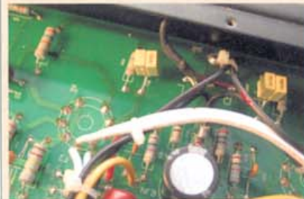
Bei unserem Mustergerät bildeten zwei parallele 100-Nanofarad-Folienkondensatoren die Eingangs-Koppelkapazitäten
