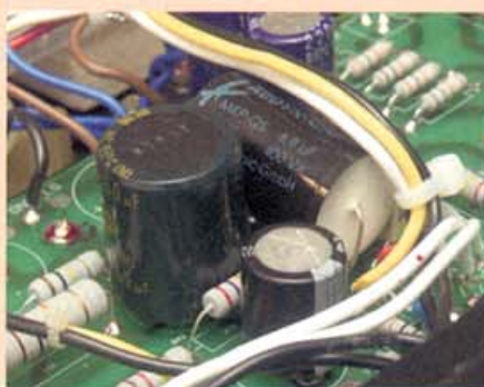
Der dicke, liegende Folienkondensator ersetzt einen roten Billigtypen, der die Betriebsspannung der Eingangsrohre puffern soll
