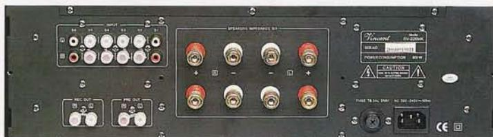
Le constructeur a prévu une sortie préampli et a doublé les sorties H.P.
